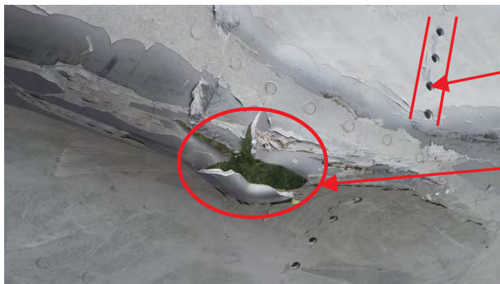
Bild 22: Art der Schäden in der Verkleidung der Boeing 777
