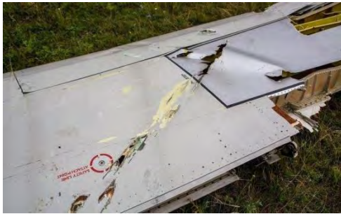
Bild 1: Fragment des Flügels der Boeing 777
