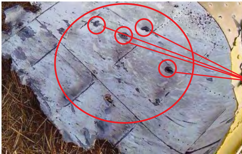
Bild 21: Art der Schäden in der Verkleidung der Boeing 777
