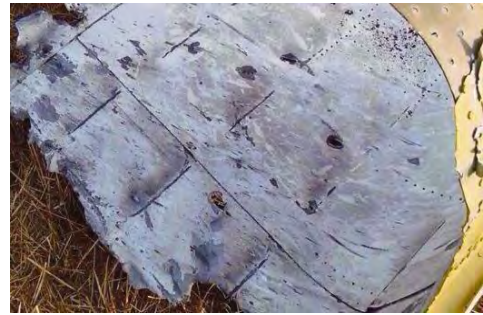
Bild 2: Fragment der Verkleidung der Boeing 777
